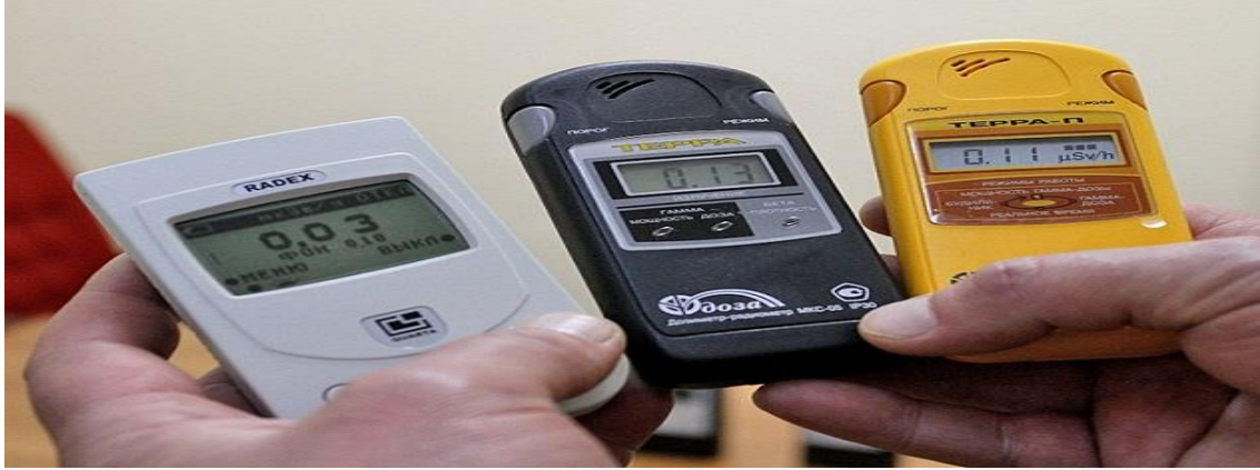
شكل (4) قياس التعرض الإشعاعي
